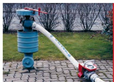
• Durchflussmengenmessung am Überflurhydranten.
