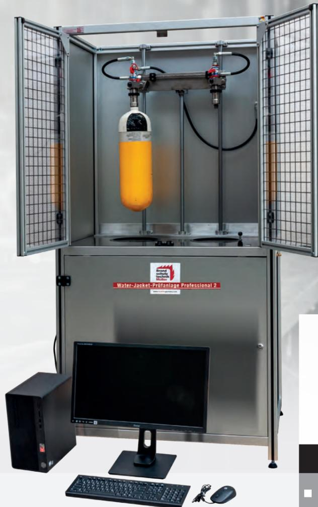
• Art.-Nr. 186615 Water-Jacket -Prüfanlage Professional 2 dient der volumetrischen Prüfung der Ausdehnung von Composite-Druckgasflaschen unter Druck.
