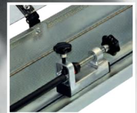
• Prüfung eines Dauerdruck-Feuerlöserschlauches, der mit dem in Längsrichtung beweglichen Düsenverschluß des SPGV verschlossen ist.
