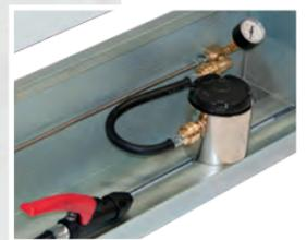
• Prüfung eines Sicherheitsventils mit einem Ventilprüfkopf.
