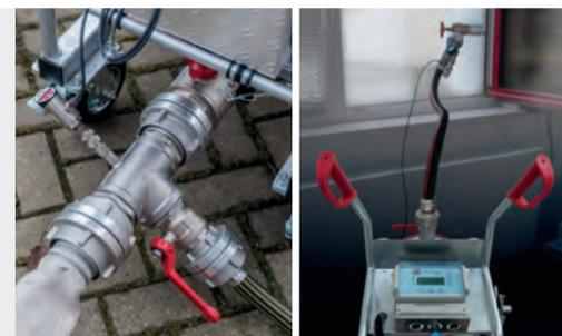
Nachdem die Leitung auf Vollständigkeit und Funktionsfähigkeit der Ventile und anderer Einrichtungen geprüft wurde, muss sie vollständig mit Wasser gefüllt werden. Dabei werden die **Hydrantenprüfpumpe HPP**, das **DMT 600** und die Steigleitung verbunden. Anschließend kann mit der **Hydrantenprüfpumpe HPP** die statische Druckprobe durchgeführt werden. Die Bestimmung der Druckdifferenz bei vorgegebener Durchflussmenge von 600 L/min erfolgt im Anschluss an die Druckprobe.
