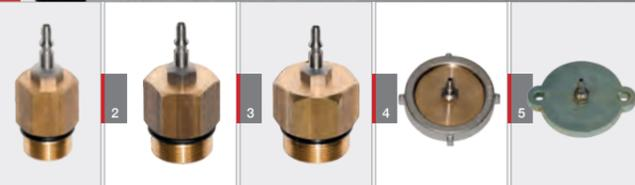
Mit dem Hydrotestgerät HTG 60 können mit einem Prüfdruck von bis zu 60 bar bis zu fünf Behälter von Pulver-, Wasser- oder Schaum-Handfeuerlöschern gleichzeitig geprüft werden.
