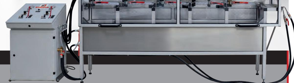
• Das Hydrotestgerät HTG 500 / 60 ist eine Kombination der Geräte HTG 500 und HTG 60. Es ist eine Anlage mit Allroundeigenschaften, mit der alle Feuerlöcherbehälter und Druckgasflaschen mit dem entsprechenden Prüfdruck getestet werden können.
