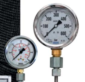
• An den beiden Prüfmanometern kann der eingestellte Prüfdruck exakt abgelesen werden.
