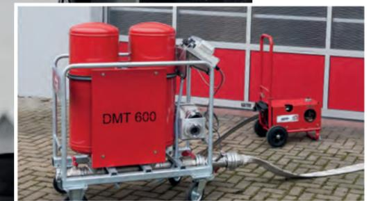
• Durchflussmessgerät DMT 600 im Einsatz.
