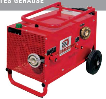
Der eingestellte Druck ist am glyzeringefüllten Manometer ablesbar. Das automatische Rückschlagventil verhindert beim Druckaufbau einen Rücklauf. Die Handhabung ist einfach: Mit einem Kugelhahn am Gerät wird der Prüfling mit Wasser gefüllt. Anschließend wird der Druck aufgebaut. Nach der Prüfung wird mit einem 2. Kugelhahn druckentlastet. Wassereingang und -ausgang sind mit C-Storz-Festkupplungen, bzw. 1 Zoll AG bei der 60-bar-Version der **HPP** ausgerüstet. Als Zubehör für den
