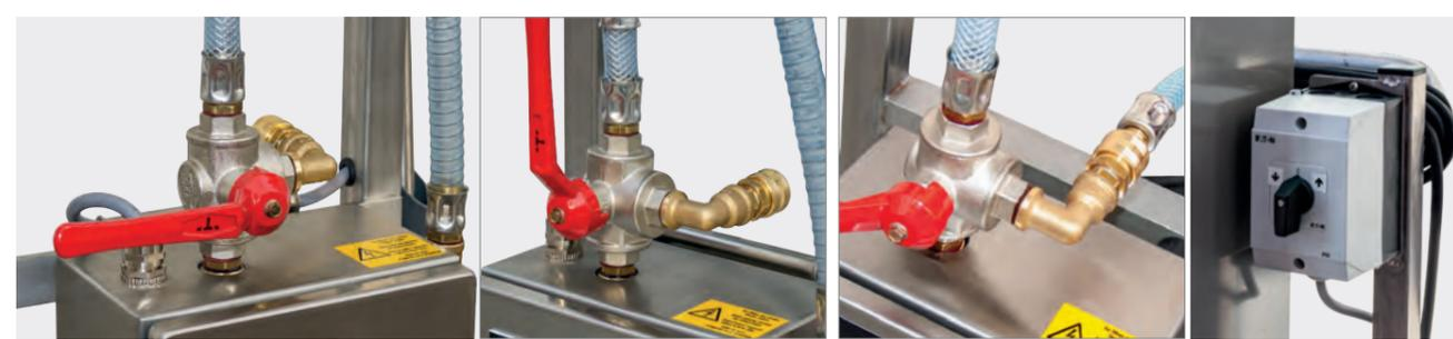
Das Entleeren und Befüllen des Feuerlöschers erfolgt durch eine bidirektional arbeitende, schaummittelbeständige Elektropumpe mit einer Leistung von 15 l/min.
